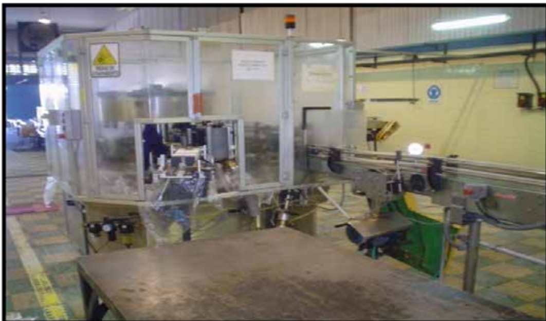
Figura 10. Etiquetadora de 266 Botellas por Minutos Autor: Hernández, D y Laguna, A (2018)
