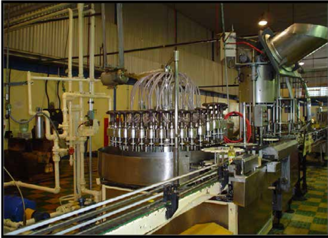
Figura 9. Llenadora Rotativa de la Línea en la Empresa Industrias Diana. Autor: Hernández, D y Laguna, A (2018)
