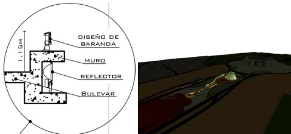
Figura 27. Detalle de Baranda con reflector. Iluminación central por parte del cono de vidrio.
