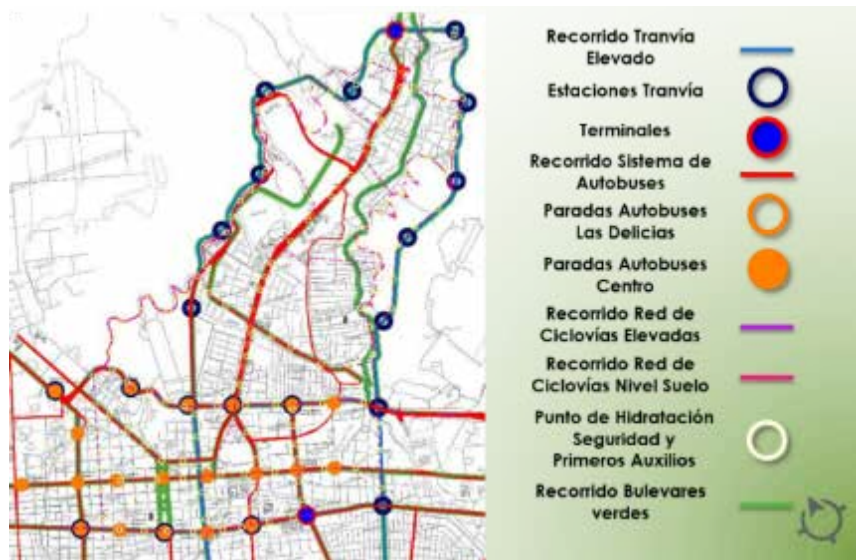
Figura 24. Plano de todos los sistemas de transporte propuestos.
