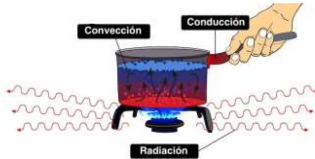
Figura 4. Diferencia entre las tres transferencias de calor.
