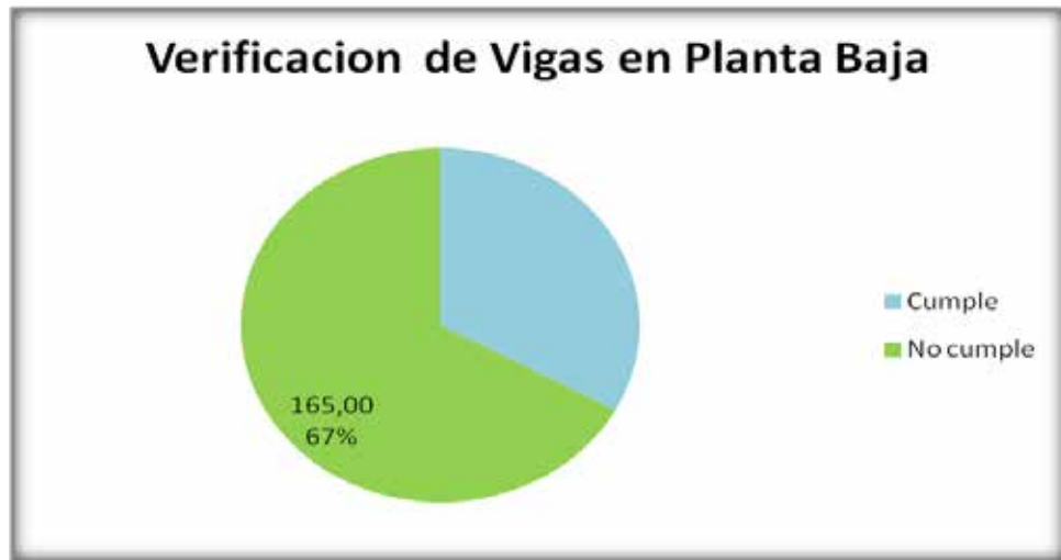
Figura 23. Porcentaje de Vigas que Requieren acero longitudinal en Planta Baja Modulo 2
