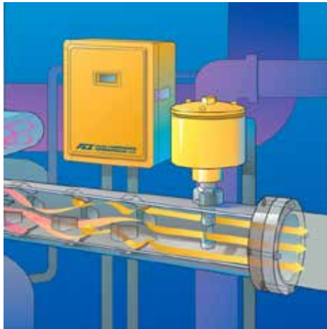
Figura 3. Flujo en tubería con caudalímetro. Fuente Hansen (2004)
