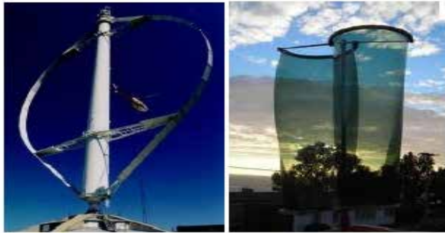
Figura12: Aerogeneradores de eje vertical tipo Darrieux y tipo Savonius Fuente: Villarrubia (2011)
