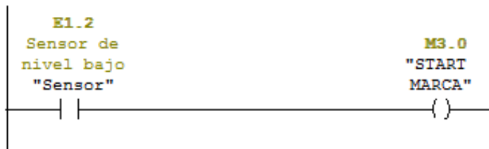
Figura 24. Sensor por falta de gránulos de plástico Fuente: Rivas (2021).
