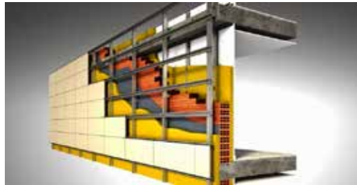
Figura 24. Detalle colocación de lámina de alucobond , fuente Google,
