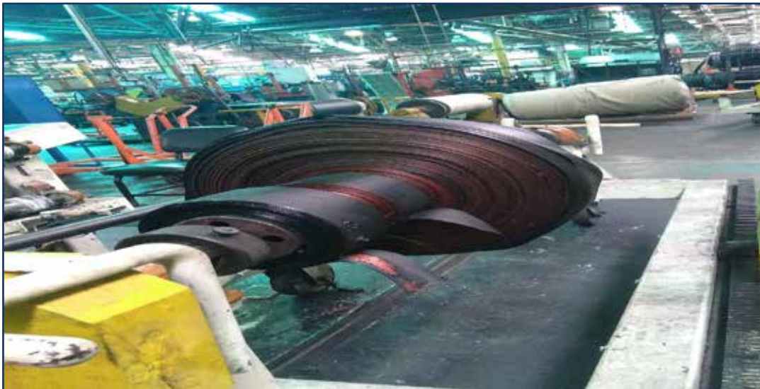
Figura 1. Desperdicio de tela cortada en los cilindros enrolladores de tela. Fuente: Tomado de Alice Neumáticos de Venezuela C.A. (Mayo 2019).
