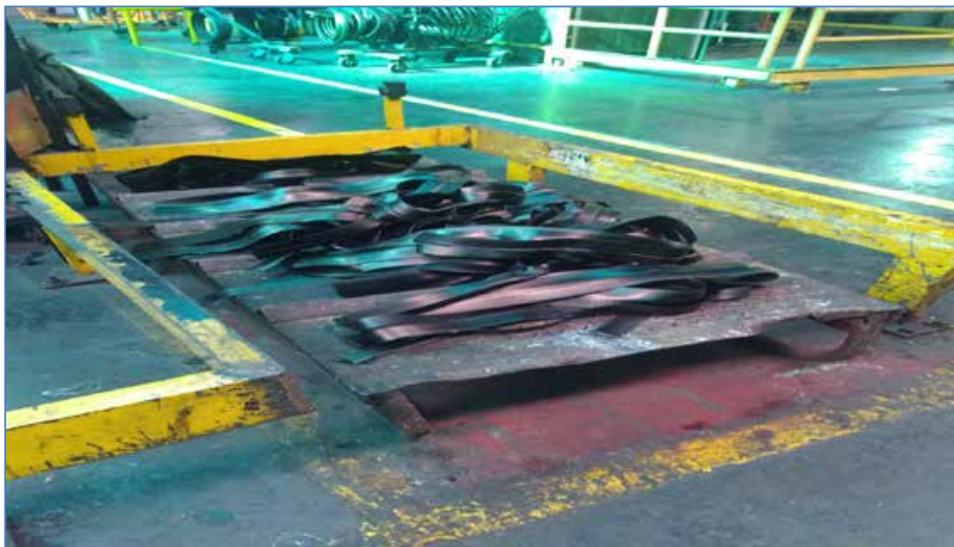
Figura 6. Desperdicio Máquina Cortadora Banner 1. Fuente: Tomado de Alice Neumáticos de Venezuela. C.A. (2019)
