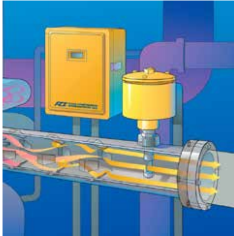
Figura 19. Flujo en tubería con caudalímetro.
