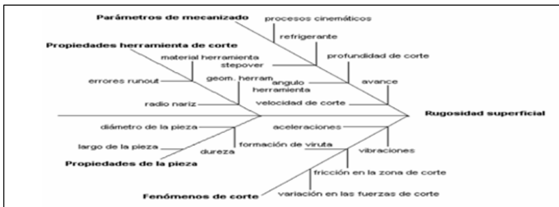
Figura 16. Diagrama causa-efecto de los factores que afectan el acabado superficial. Fuente López F.P. Cavazos R, Delgado M. (2003) “caracterización de superficies maquinas por medio por medios parámetros de rugosidad”. Ingenierías Vol.6 No 18, pp 62-68.
