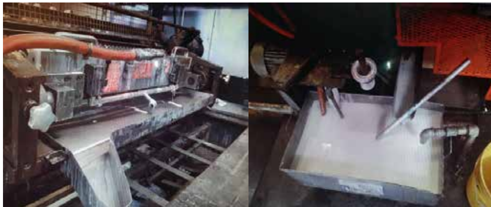
Figura 5. Rodillo anilox, utilizado para la impresión del diseño.
