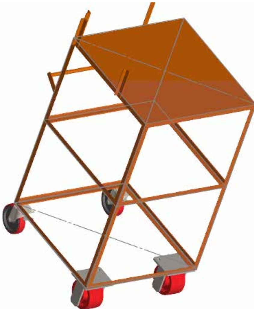
Figura 11. Escuadra porta láminas. Material constitutivo acero al carbono. Densidad del material: 7850 \text{ Kg/m}^3 . Masa aproximada: 139 Kg. Ruedas en poliuretano acero de 8 x 2".
