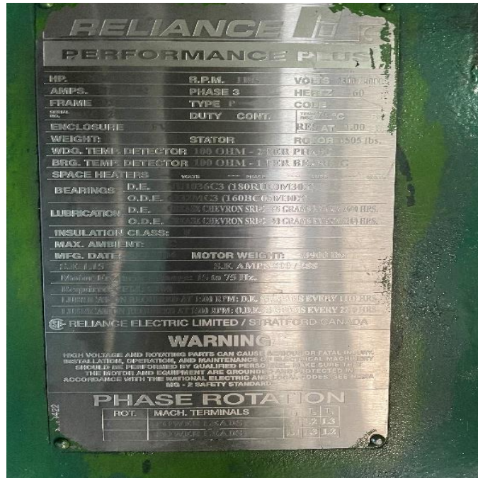
Figura 40: Datos de la chapa del Banbury 4
