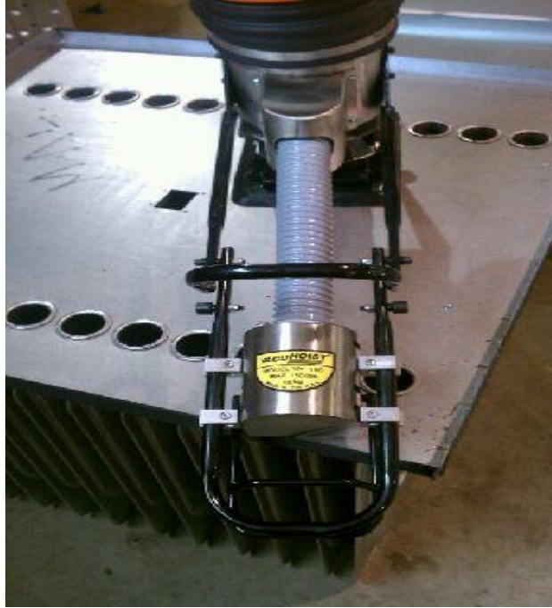
Figura 64: Cabezal de control VH160 con mango Flex, número de pieza 56050
