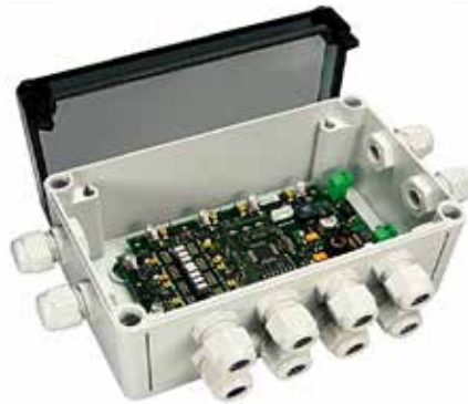
Figura 9. Multiplexor electrónico de FQ Ingeniería Electrónica S.A.
