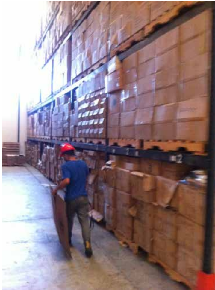
Figura N°6. Falta de identificación de los racks.
