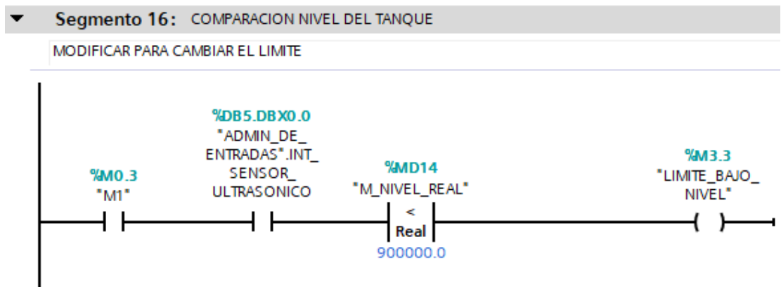
Figura 59. Alarma límite del nivel del tanque
