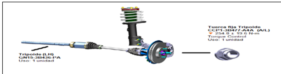
Figura 31. Ensamble conjunto Disco - Mac Pherson
