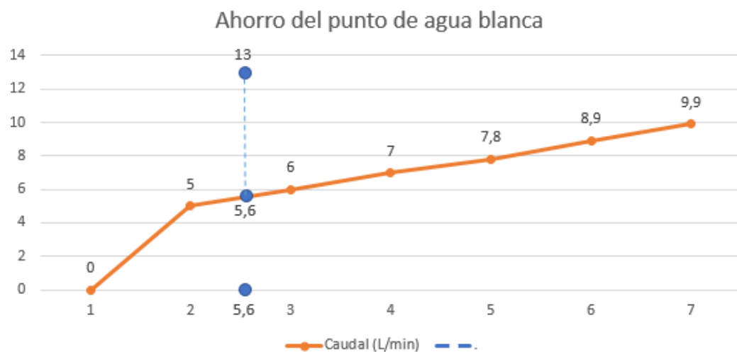
Gráfica 6. Caudal vs Presión de la válvula antirretorno en puntos de agua blanca.
