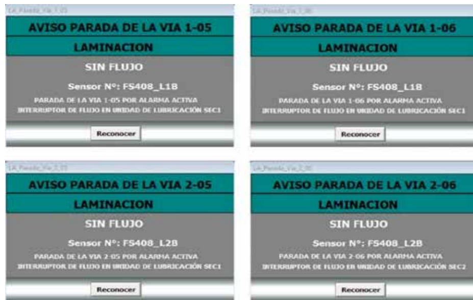
Figura 63. Aviso de vías detenidas por flujo unidad de lubricación, sección 1 y 2.
