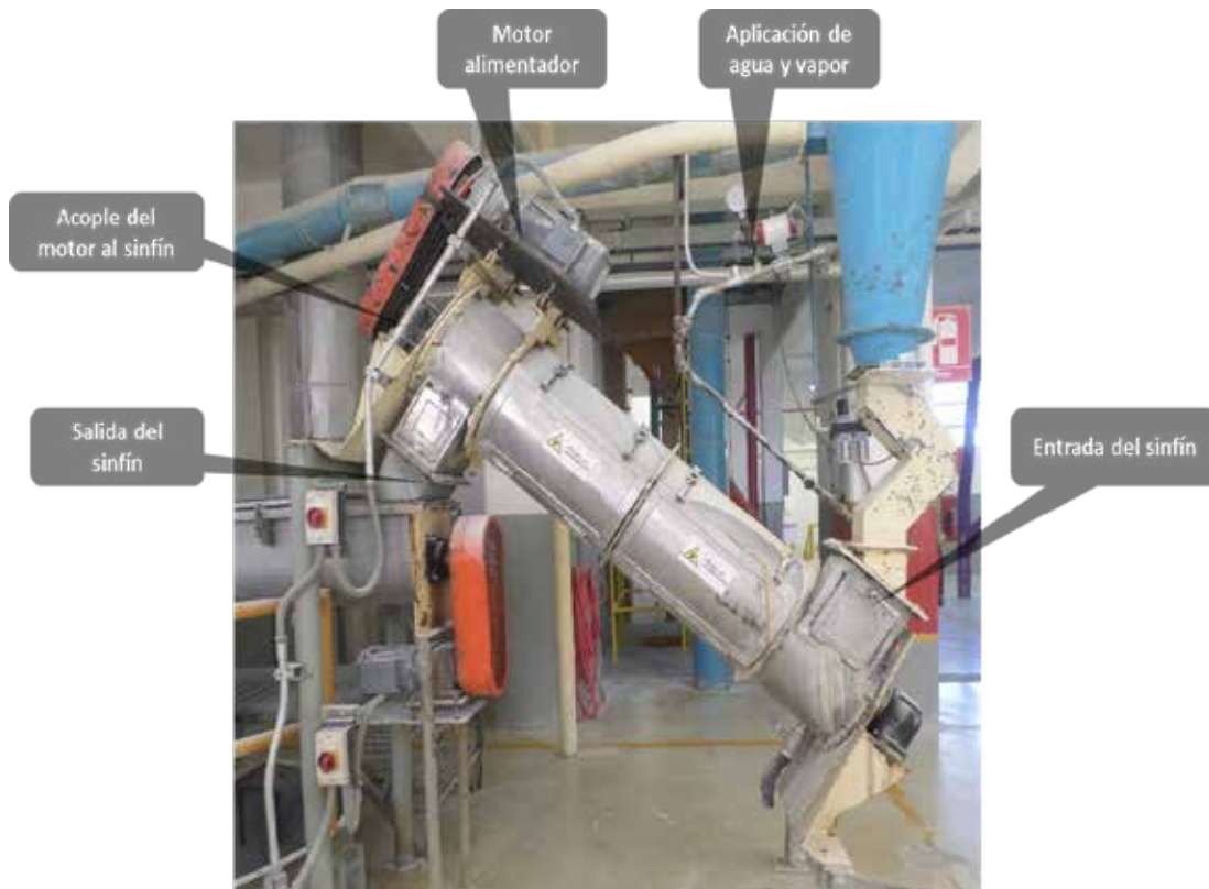
Figura 12. Mezclador de premojo intensivo.
