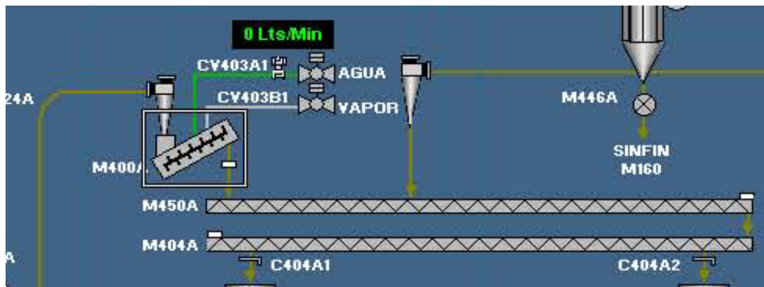
Figura 10. Área de premojo en el proceso de laminación, Supervisorio del SCADA.
