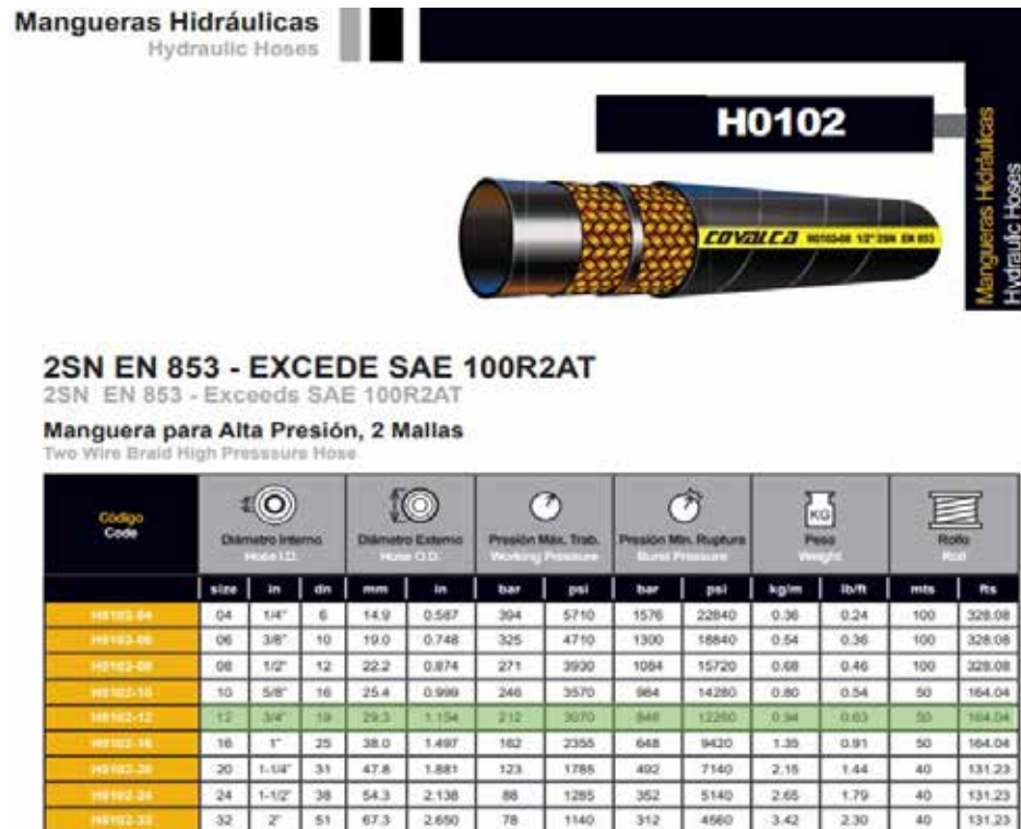
Figura 16. Manguera de salida en la unidad de lubricación del laminador.
