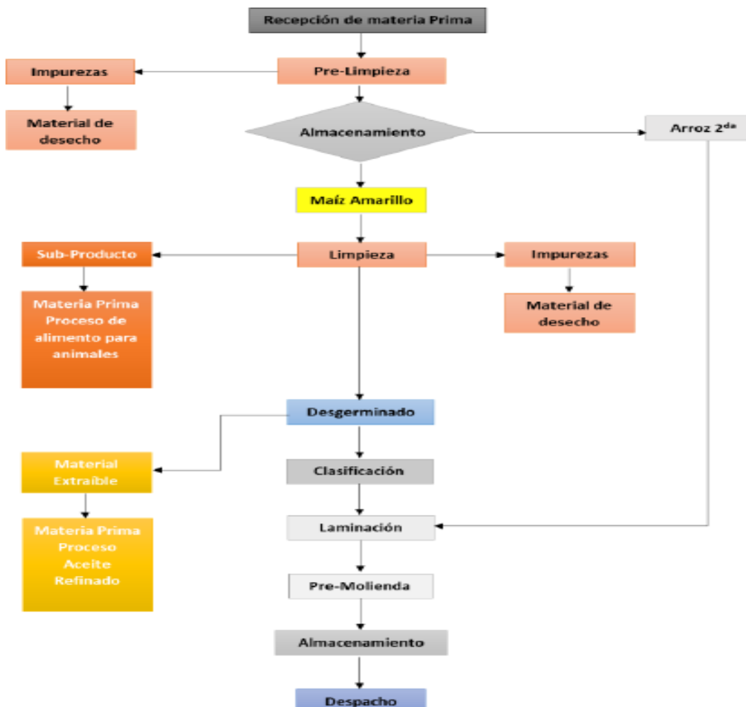
Figura 4. Diagrama del proceso productivo en la elaboración de hojuela cervecera.
