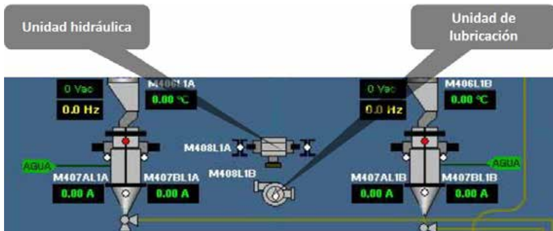
Figura 11. Unidad hidráulica y de lubricación del laminador, Supervisorio del SCADA.
