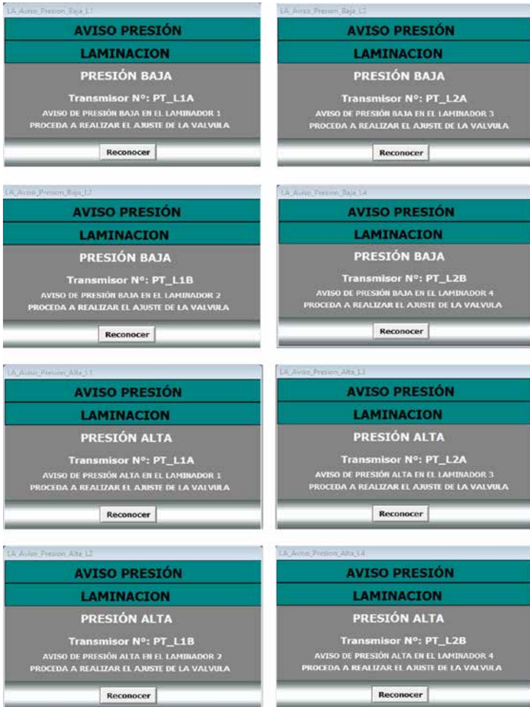
Figura 49. Ventanas de aviso para presión baja y alta en los laminadores.
