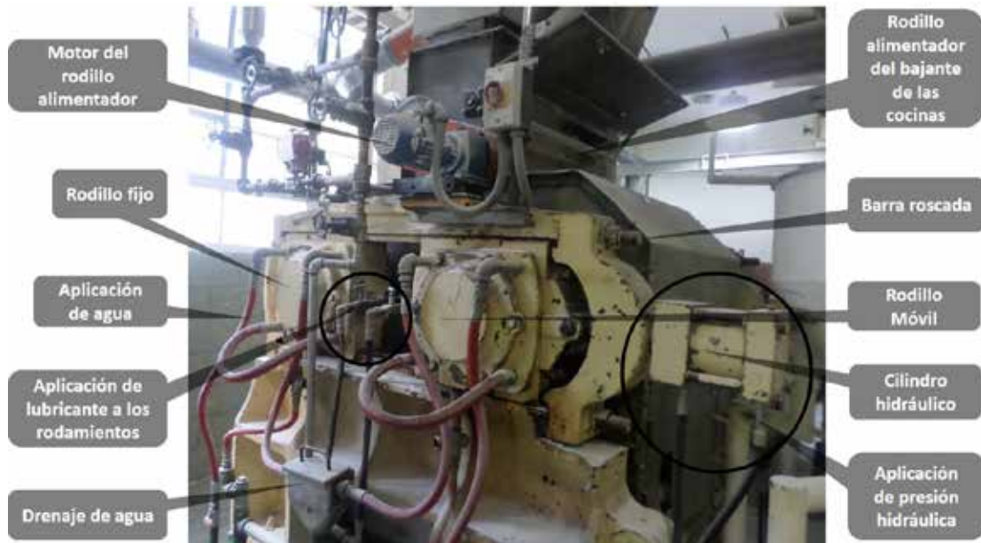
Figura 14. Molino Laminador vista lateral.
