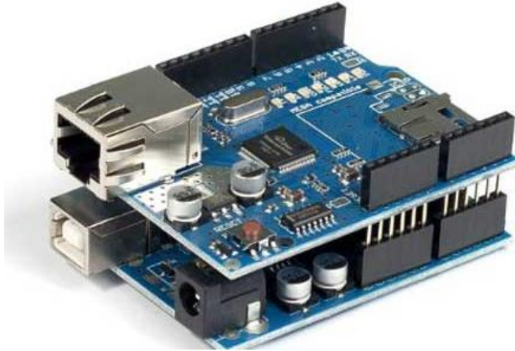
Figura 25. Conexión de Arduino UNO con Ethernet Shield Fuente: Sáez (2022).
