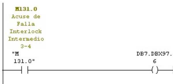
Figura 84. Acuse de falla de disponibilidad intermedio del conductor de molino 4 y 5 y falla de interlock del conductor de molino 3 y 4.
