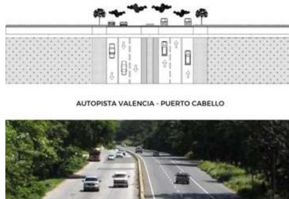
Figura 11: Perfil Vial de Autopista Valencia – Puerto Cabella.
