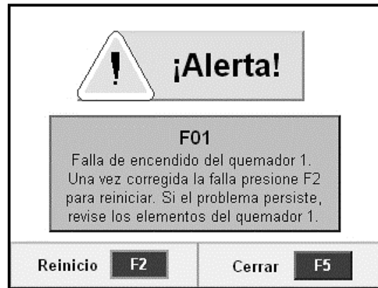
Figura 20. Ventana de alarma F01 en la pantalla HMI
