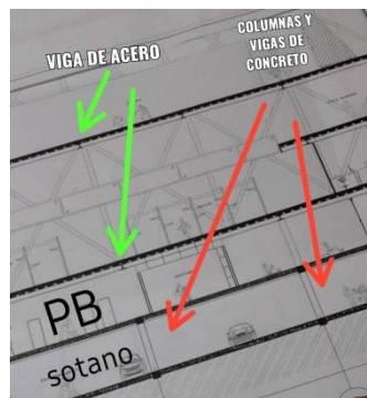
Figura 32. Estructura en corte. (2020)
