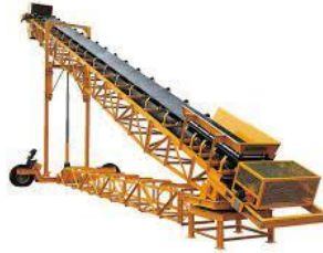
Figura 6. Sistema de transporte por banda
