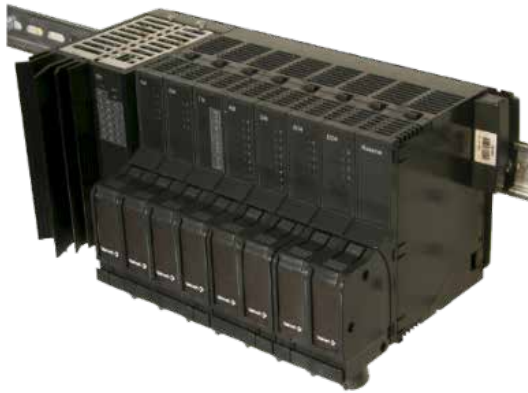
Figura 36. Modulo I/O M80 Fuente Valmet (2016)
