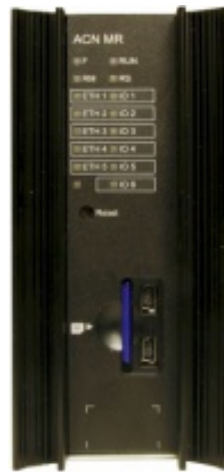
Figura 33. Controlador ACN MR Fuente Valmet (2016)
