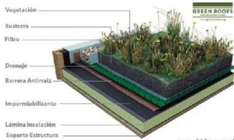
Figura 64. Detalle de Techo Verde. Fuente: http://dearkitectura.blogspot.com/2012/06/que-es-un-techo-verde.html (2017)
