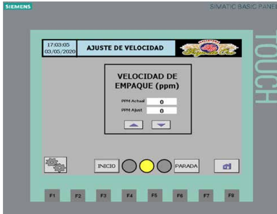
Figura 73. Ajuste de velocidad de empaque Fuente: Lopiparo (2020)
