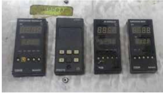
Figura 28. Termostatos de rodillos y mordazas selladoras
