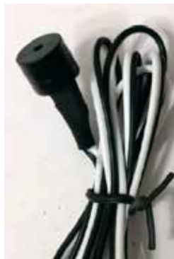
Figura 44. Buzzer indicador de falla para los equipos Cavanna 07 y 011
