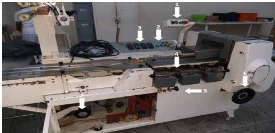
Figura 22. Vista frontal para los controles de la empaquetadora cavanna 011 Fuente: Lopiparo (2020)
