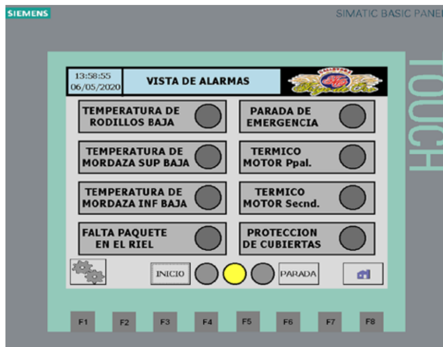
Figura 74. Vista de alarmas del proceso Fuente: Lopiparo (2020)
