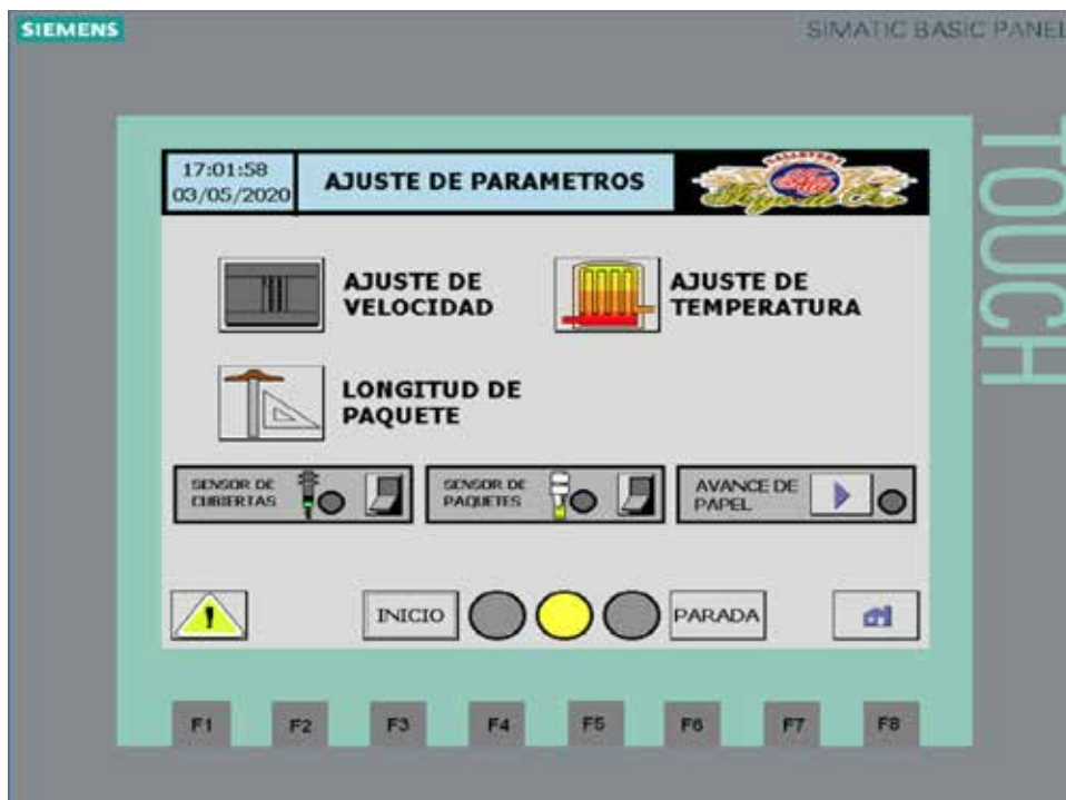
Figura 70. Ajuste de parámetros del proceso de empaque Fuente: Lopiparo (2020)
