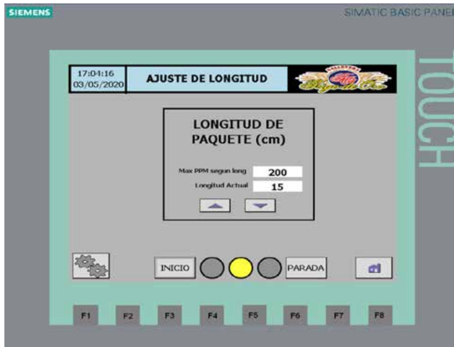
Figura 72. Ajuste de longitud de paquetes Fuente: Lopiparo (2020)
