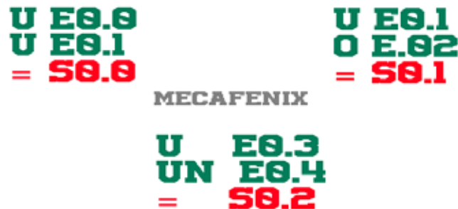
Figura 15. Programación usando lenguaje tipo lista de instrucciones
