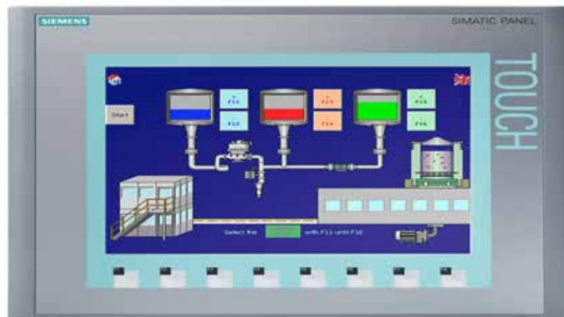
Figura 46. HMI KTP 1000 DP Siemens Fuente: https://images.app.goo.gl/DVE4p99er7jvzo2A8
