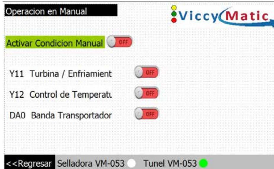
Figura 93. Interfaz de activación de motores eléctricos y controlador. Elaborado por: Crupi A., Valera J. (2021).
