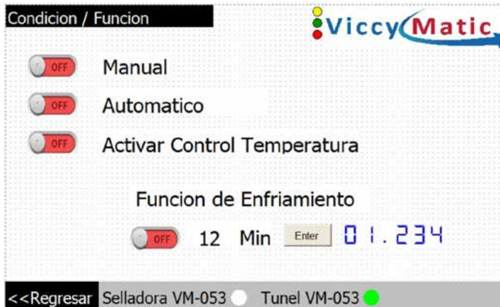
Figura 89. Interfaz de mando de la cámara de calentamiento. Elaborado por: Crupi A., Valera J. (2021).
