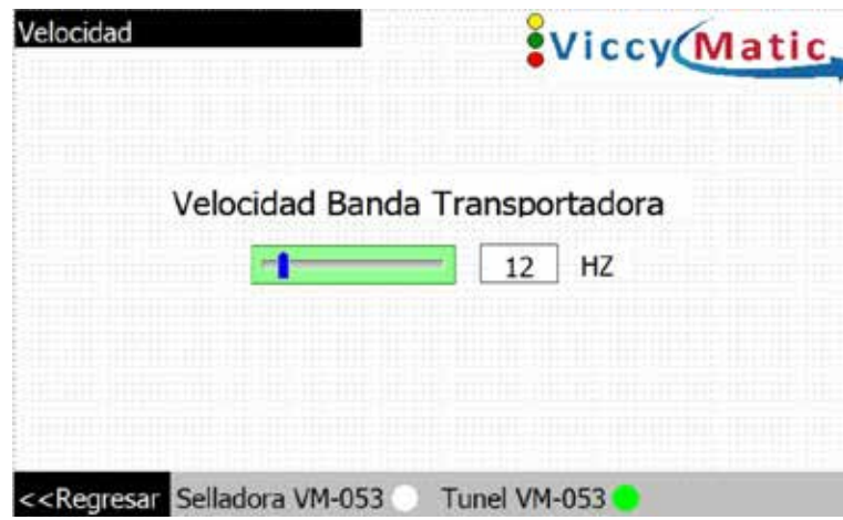
Figura 95. Interfaz de velocidad de banda transportadora VM-BT-02.
