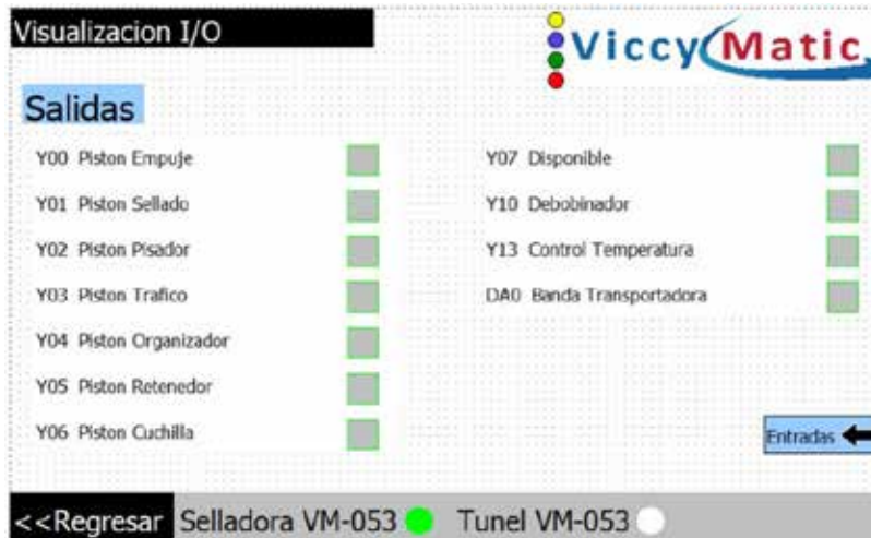
Figura 83. Interfaz de visualización de periféricos de salida. Elaborado por: Crupi A., Valera J. (2021).
