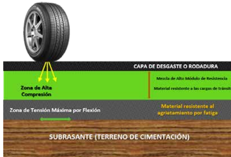
Figura 7. Estructura de Pavimentos de Larga Duración
