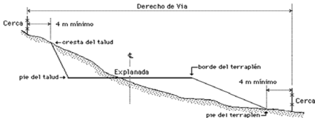
Figura 10. Derecho de vía
