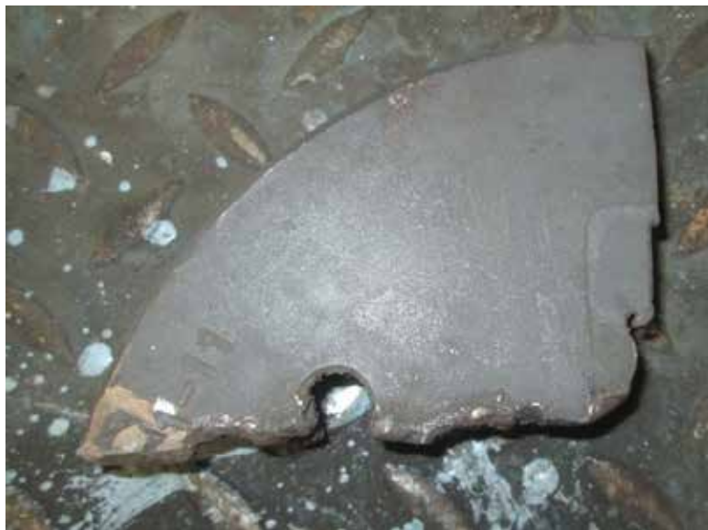
Fig. 16 Trozo de matriz seleccionada para análisis químico.
