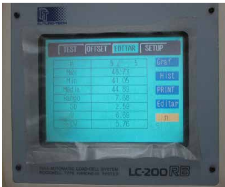
Fig. 19 Dureza después de tratamiento, matriz 1413 – 4
