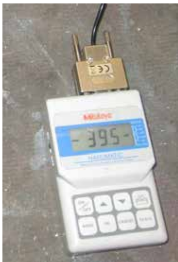
Fig. 18 Dureza promedio de matriz solida 1413 – 4
