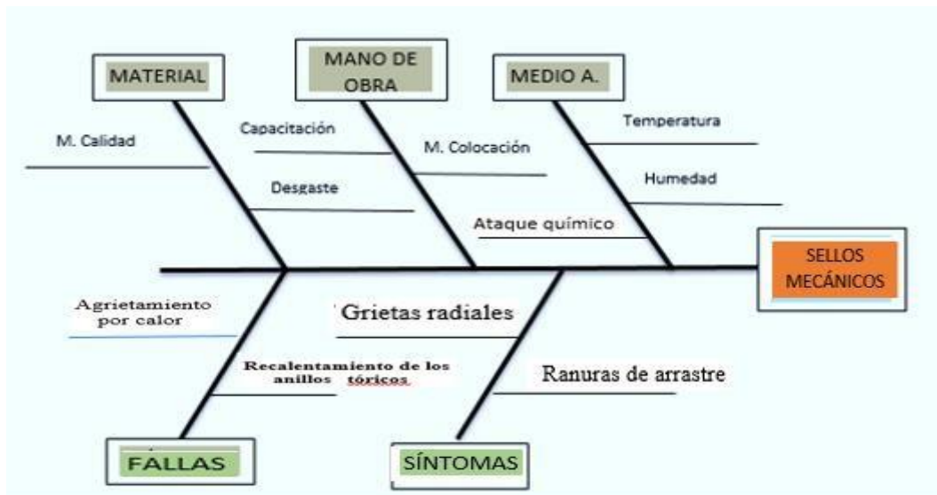
Figura 19 Fallas en los sellos por agrietamiento y recalentamiento
