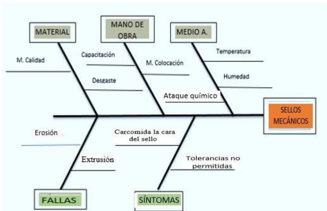
Figura 20 Fallas sellos por erosión y extracción
