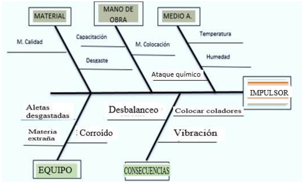
Figura 25 Falla debido al rodete
