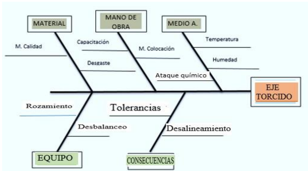
Figura 27 Fallas debida a un eje torcido
