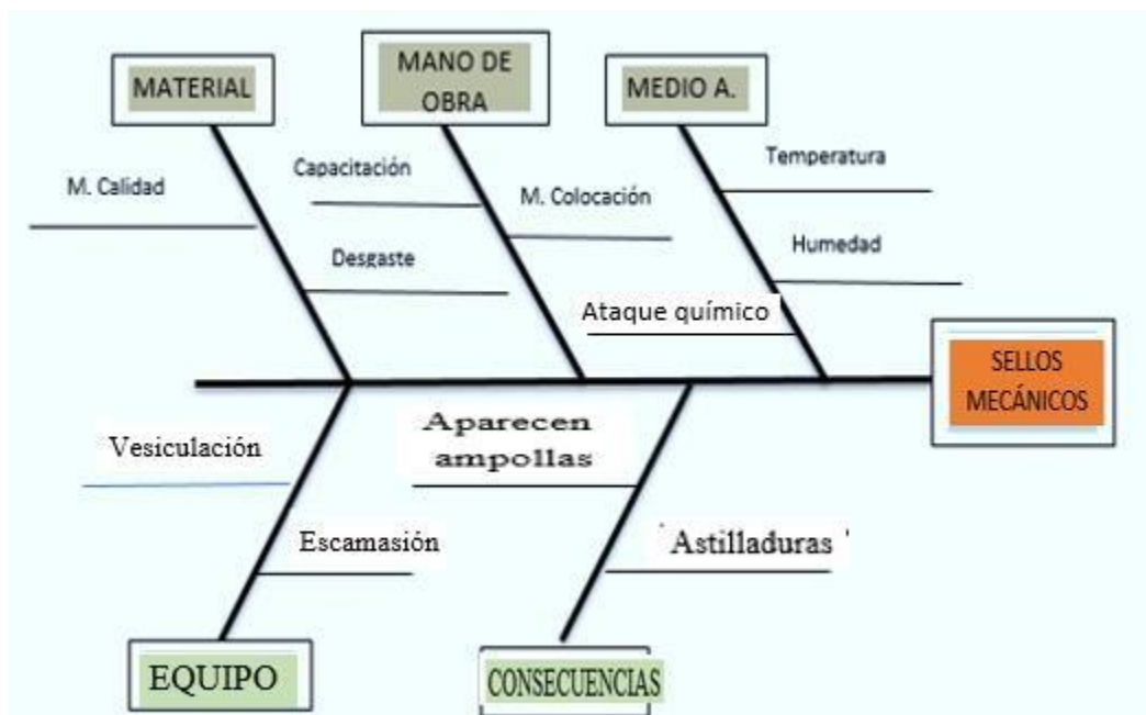
Figura 21 Falla en los sellos por vesiculación y escamación
