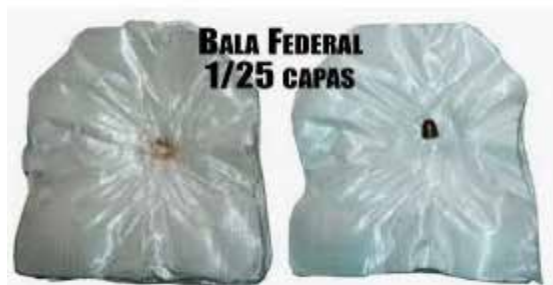
Figura 22. Deformación de las capas del chaleco antibalas
