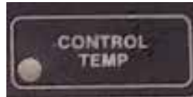
Figura 30. Selector para el Control de Temperatura
