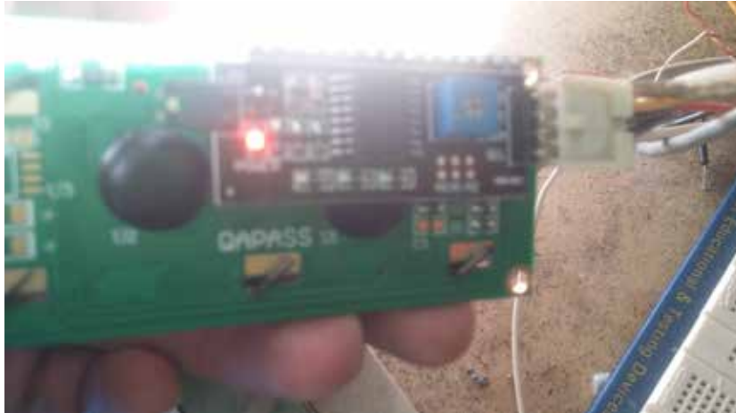
Figura 42. Pantalla LCD 16x2 con Modulo I2C Integrado Fuente: López Miguel (2019)
