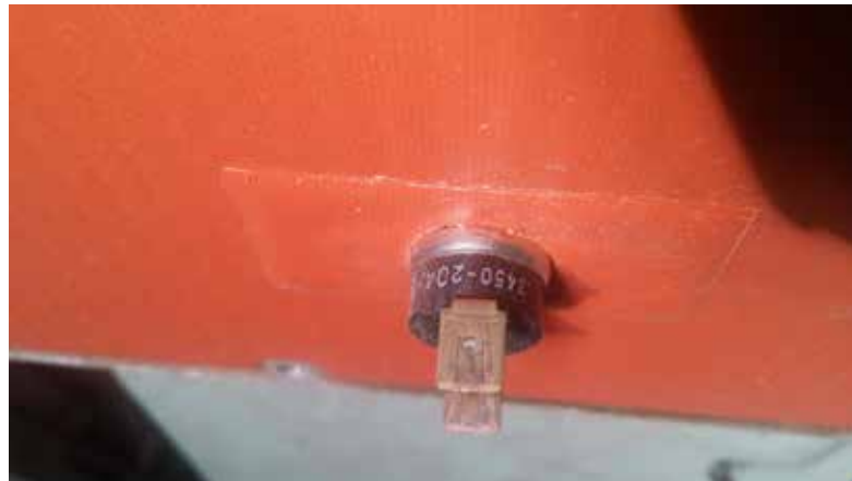
Figura 36. Termostato de Protección
