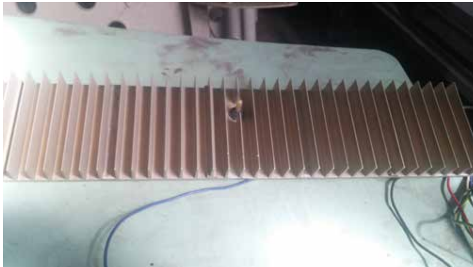
Figura 34. Resistencia Eléctrica de la Incubadora
