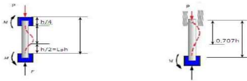
Figura 18: Representación de elementos de maquina largos sometidos a carga axial de compresión F;(a) elemento con ambos extremos empotrados; (b) elemento con un extremo empotrado y el otro guiado.
