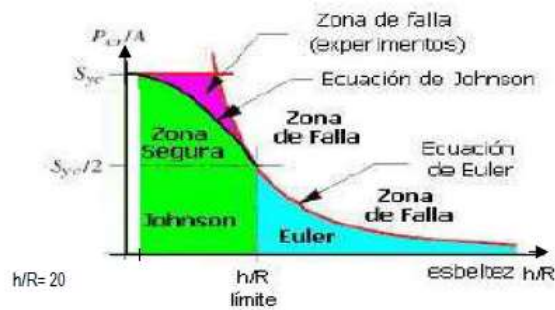
Figura 19: Representación de los criterios de Euler y de Johnson para elementos de máquinas largos sometidos a compresión Fuente: Tassoni D. (2.007).
