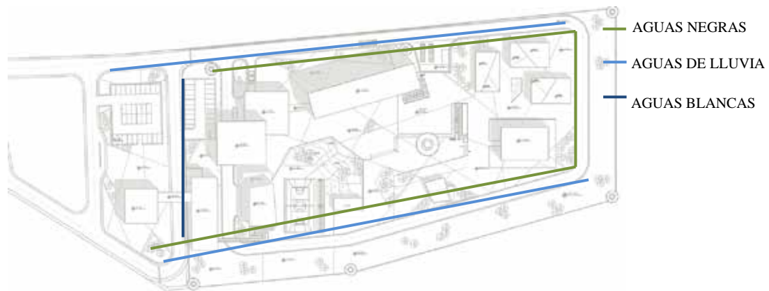
Figura 35. Redes de dotación de agua y recolección de aguas servidas y desagües (2015).
