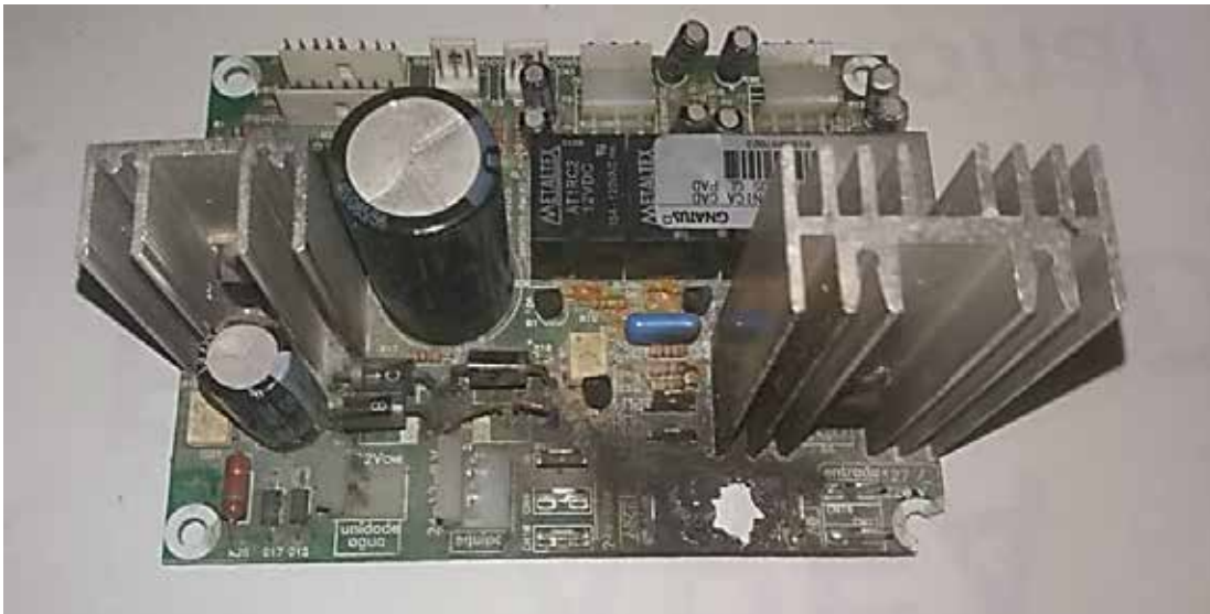
Figura 5. Anverso de tarjeta electrónica de sillón odontológico - no funcional. Fuente: Araujo y Hernández (2019).
