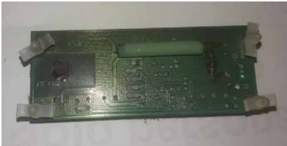
Figura 4. Reverso de tarjeta electrónica de lámpara de luz - no funcional.
