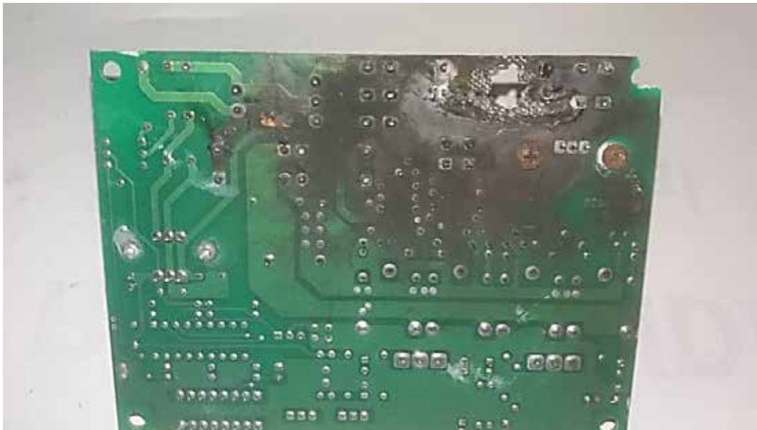
Figura 6. Reverso de tarjeta electrónica de sillón odontológico - no funcional. Fuente: Araujo y Hernández (2019).
