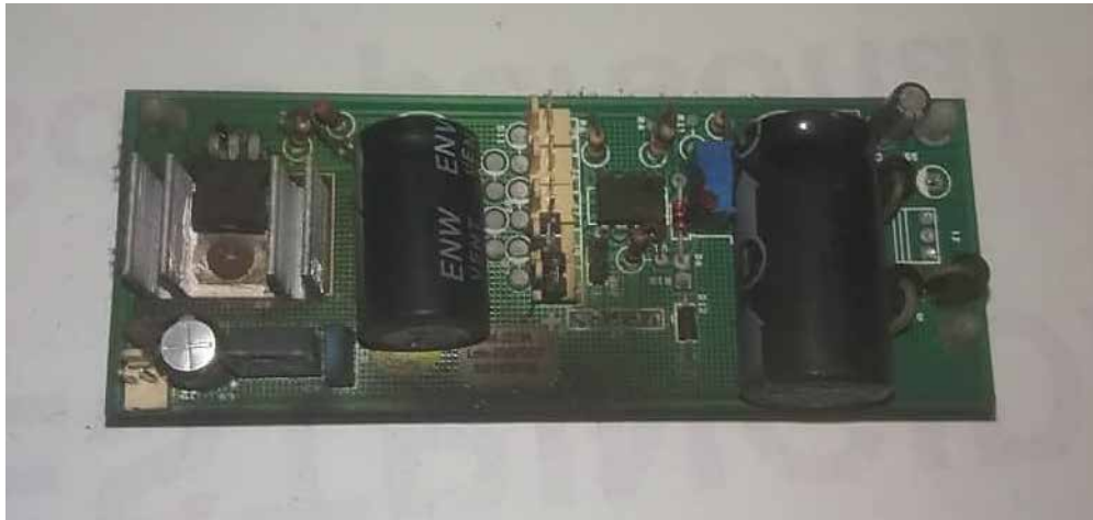
Figura3. Anverso de tarjeta electrónica de lámpara de luz - no funcional.
