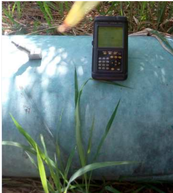
Figura 11. Medidor de Caudal Ultrasónico Modelo PT878 Fuente: Barrios M. y Escalona R., 2020
