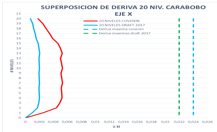
Figura número 43: superposición de derivas en dirección X de ambas normas.
