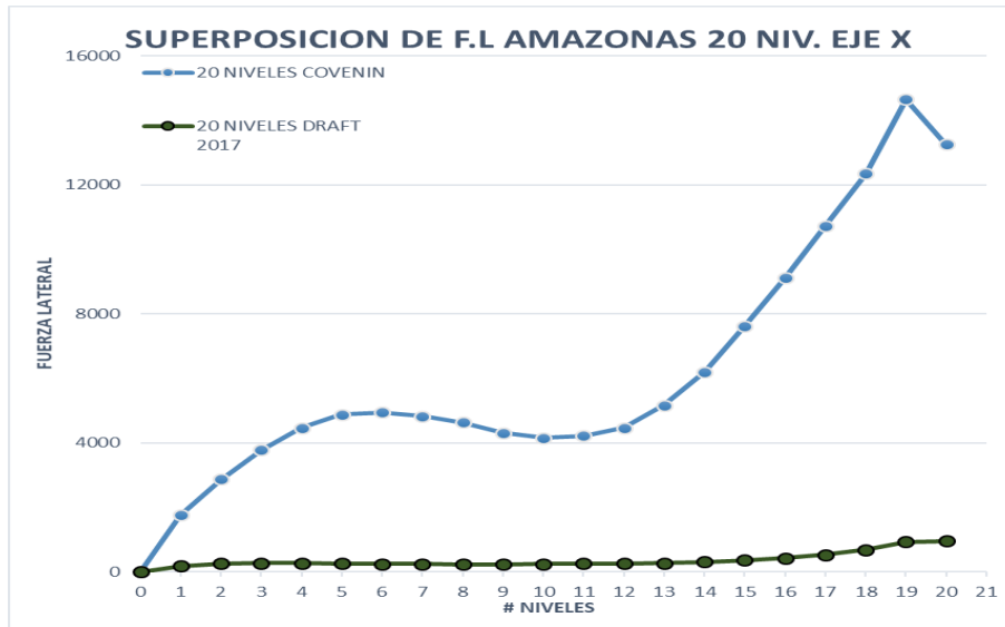
Figura número 150: superposición de fuerzas laterales en dirección X de ambas normas
