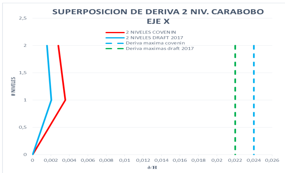
Figura número 47: superposición de derivas en dirección X de ambas normas.
