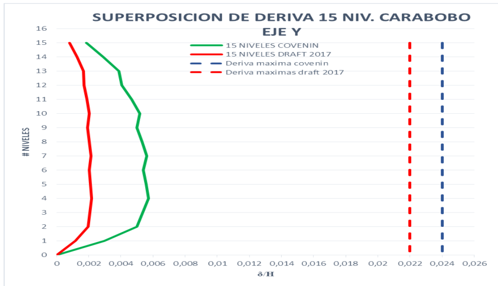
Figura número 41: superposición de derivas en dirección Y de ambas normas. Para edificaciones de veinte niveles:
