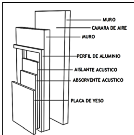
Gráfico 50. Detalle de paredes acústicas. (2015)
