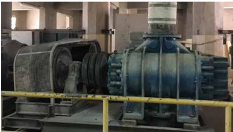
Figura 7. Recepción de materia prima por neumático de presión negativa.
