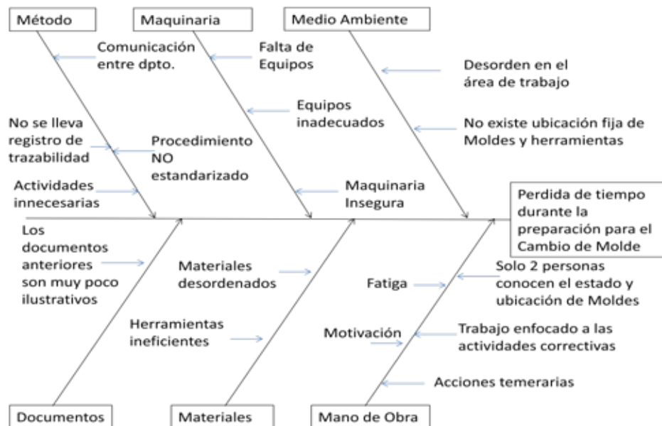
Figura20. Diagrama de Ishikawa método 6M Fuente: Briceño, M. (2020).
