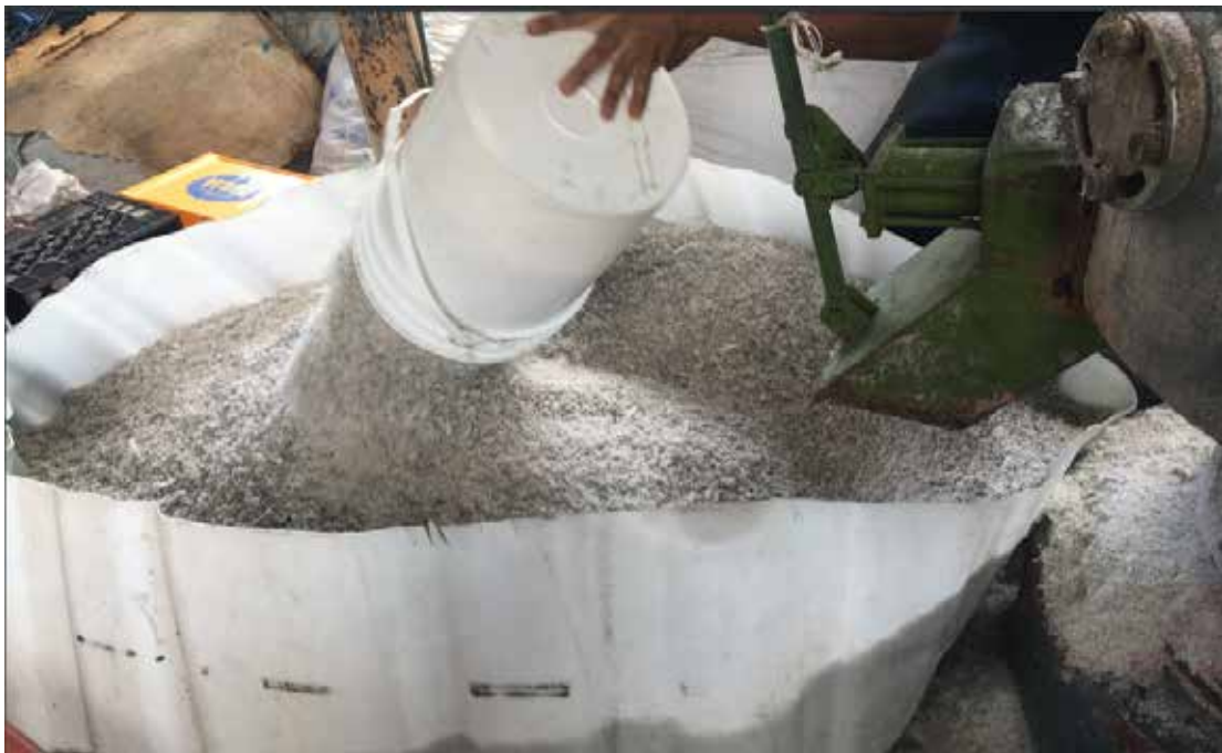
Figura 6 Obtención de las pequeñas virutas Fuente: Gómez, C. (2018)
