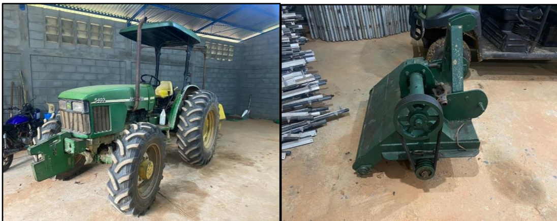
Gráfico 8. Tractor y rotocultor utilizado para el movimiento de la cama avícola.
