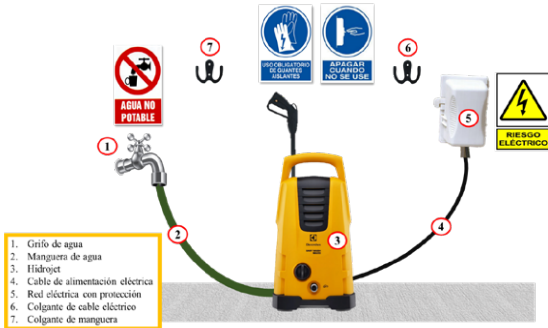
Figura 55. Área de depósito del hidrojete, con su respectiva señalización Elaborado por: Rodríguez, J (2020).
