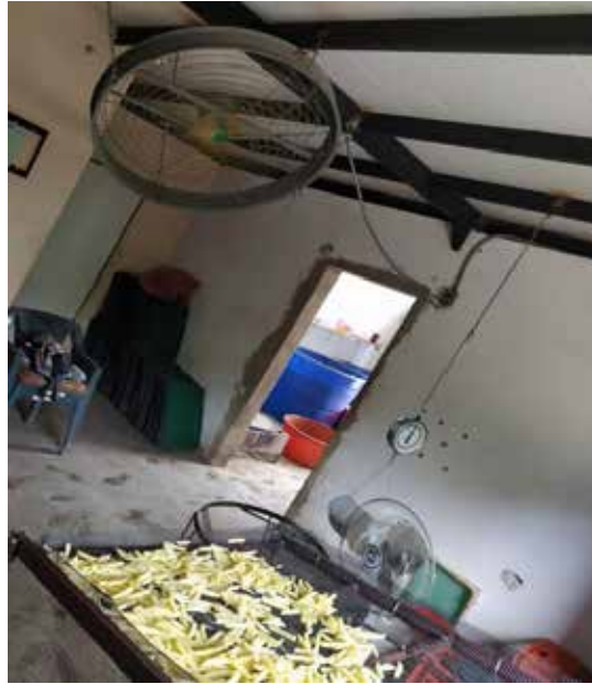
Figura 14. Ubicación del ventilador para el secado superficial de las papas.
