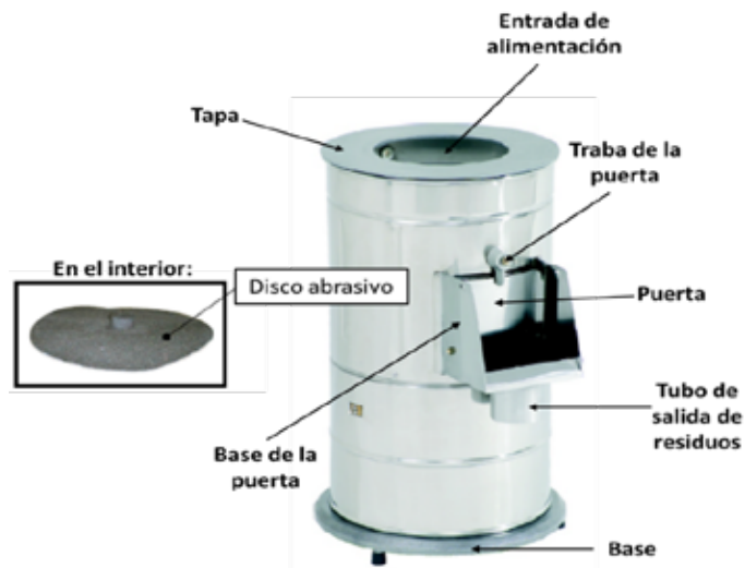
Figura 9. Partes de la máquina de pelado abrasivo centrífugo. Elaborado por: Rodríguez, J (2020).
