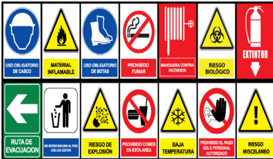
Figura 15. Señalización de Seguridad y Salud en el Trabajo.
