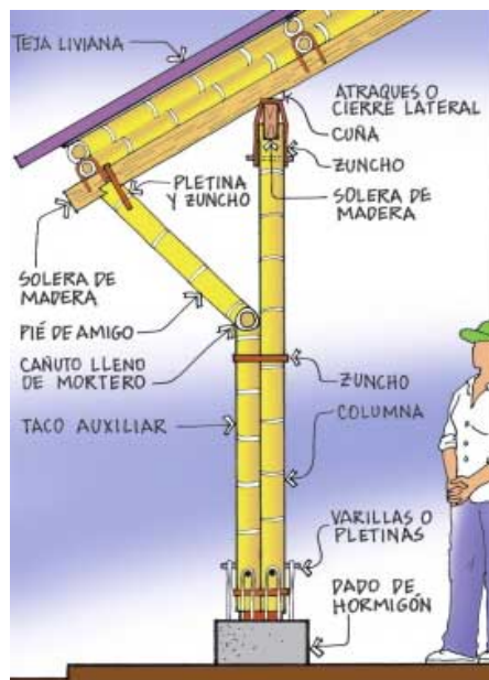
Figura 11. Columnas, vigas y cubiertas con bambú. (2015).
