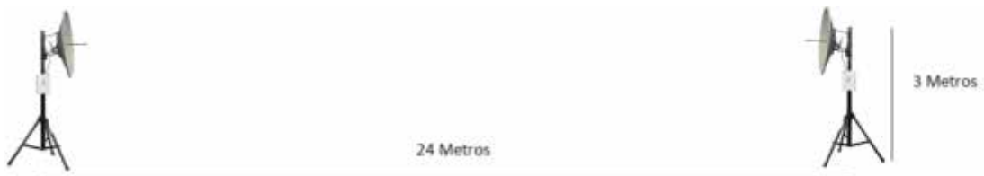
Figura 10: Colocación de las antenas
