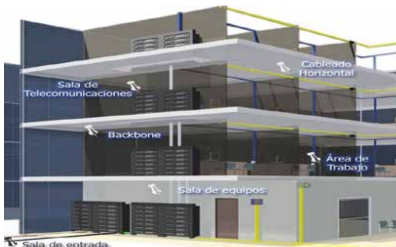
Figura 4. Analogía de un Cableado Horizontal. Fuente: www.alredsoft.com
